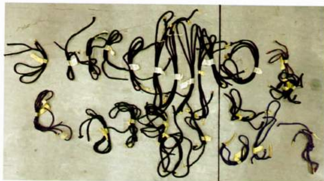
Nella pagina a sinistra, la macchina a trazione lenta impiegata per le prove di rottura degli spezzoni. Sopra, a sinistra, spezzone di cordino con segni di decadimento. Sopra, a destra, gli spezzoni di cordino sottoposti ai test della campagna di studio
