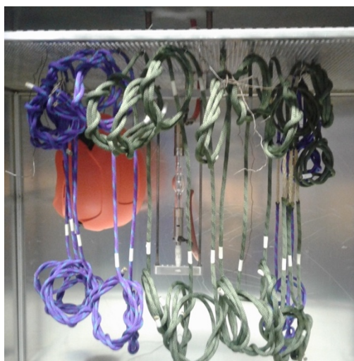
Figura 5-2 posizionamento cordini in camera UV
