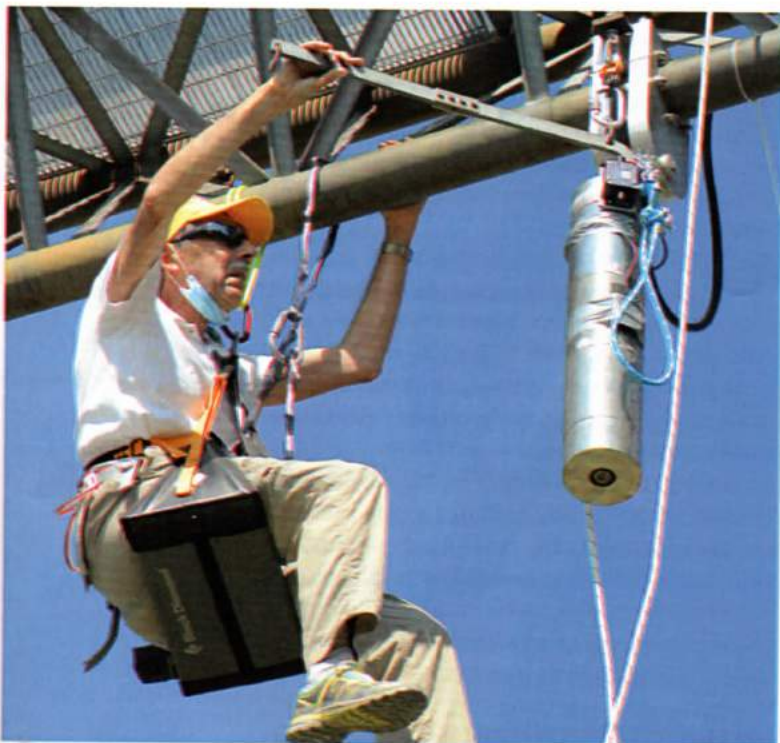
Nella pagina a sinistra, il test con il manichino. Sopra, a sinistra, la prova eseguita con la massa e, a destra, la massa in caduta collegata alla cella di carico fissata sotto il traliccio della torre
