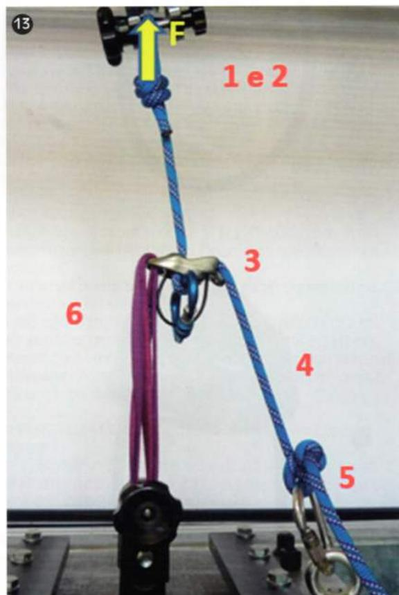
1 = dispositivo di trazione; 2 = cella di carico; 3 = dispositivo frenante; 4 = corda; 5 = collegamento fisso alla corda; 6 = punto di ancoraggio non bloccante; F = forza
