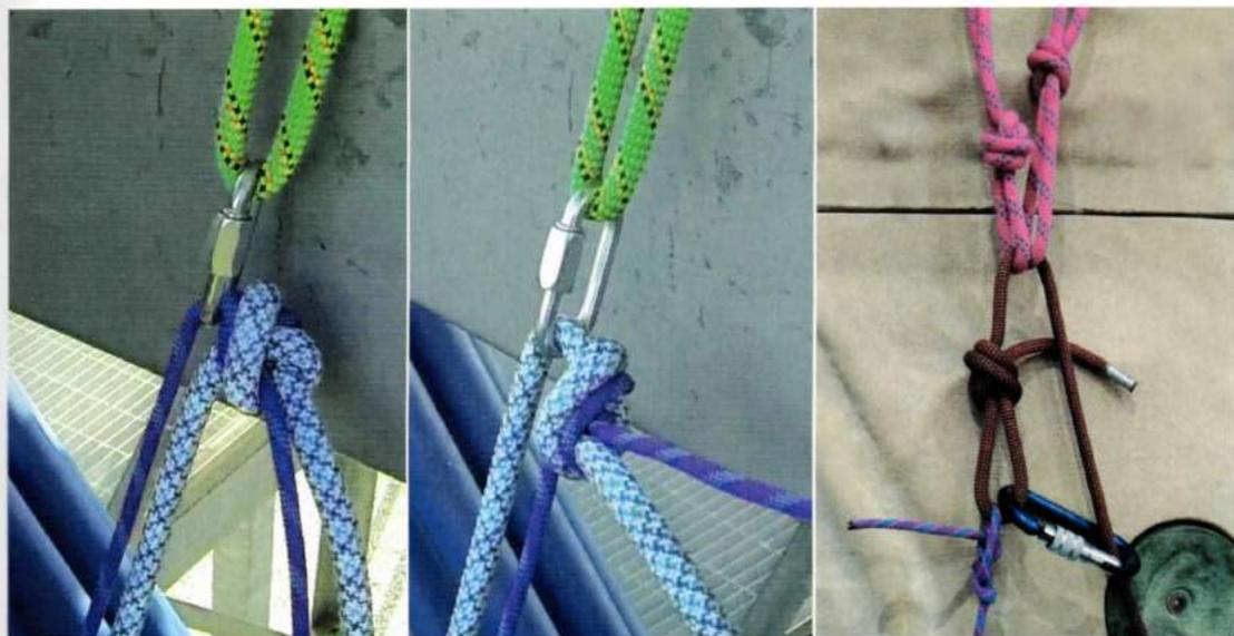
Figg. 12-13 - Posizionamento del nodo in modo scorretto (sx) e corretto (dx)
