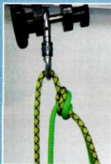
Fig. 2 - Accoppiamento testato. Modo indiretto
