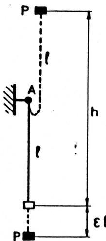
Fig. 1 - Schema di «volo» verticale con assicurazione rigida.
