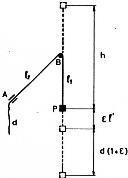
Fig. 7 - Assicurazione «dinamica»: dopo la caduta libera del peso P per una altezza h si lascia scorrere in A un tratto di corda d, in maniera da mantenere costante al valore F lo sforzo nel ramo  $l_1$ .
