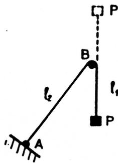
Fig. 6 - Assicurazione «rigida» a distanza dal moschettone. La corda è fissata in A e scorrevole con attrito in B.
