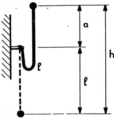
Fig. 8 - Definizione dell'altezza di caduta libera  $h$ :
