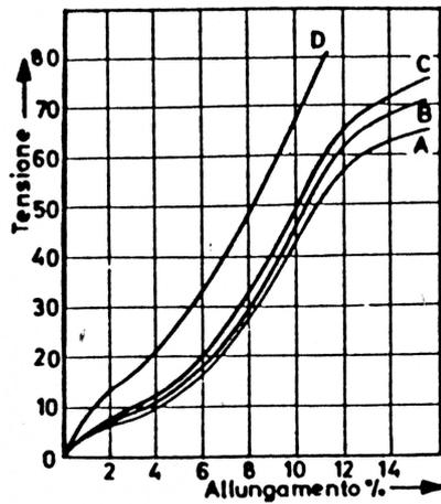
Fig. 4 - Curve tensione-allungamento per fili di nylon per varie velocità di allungamento: A = 1% per minuto; B = 10% per minuto; C = 100% per minuto; D = 29000% per minuto.
