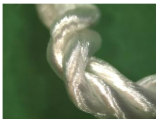
Figura 25: Trefolo della corda B. Zona di fusione lontano dal punto di rottura.
