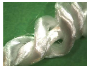
Figura 26: Trefolo della corda C. Zona di fusione lontano dal punto di rottura.
