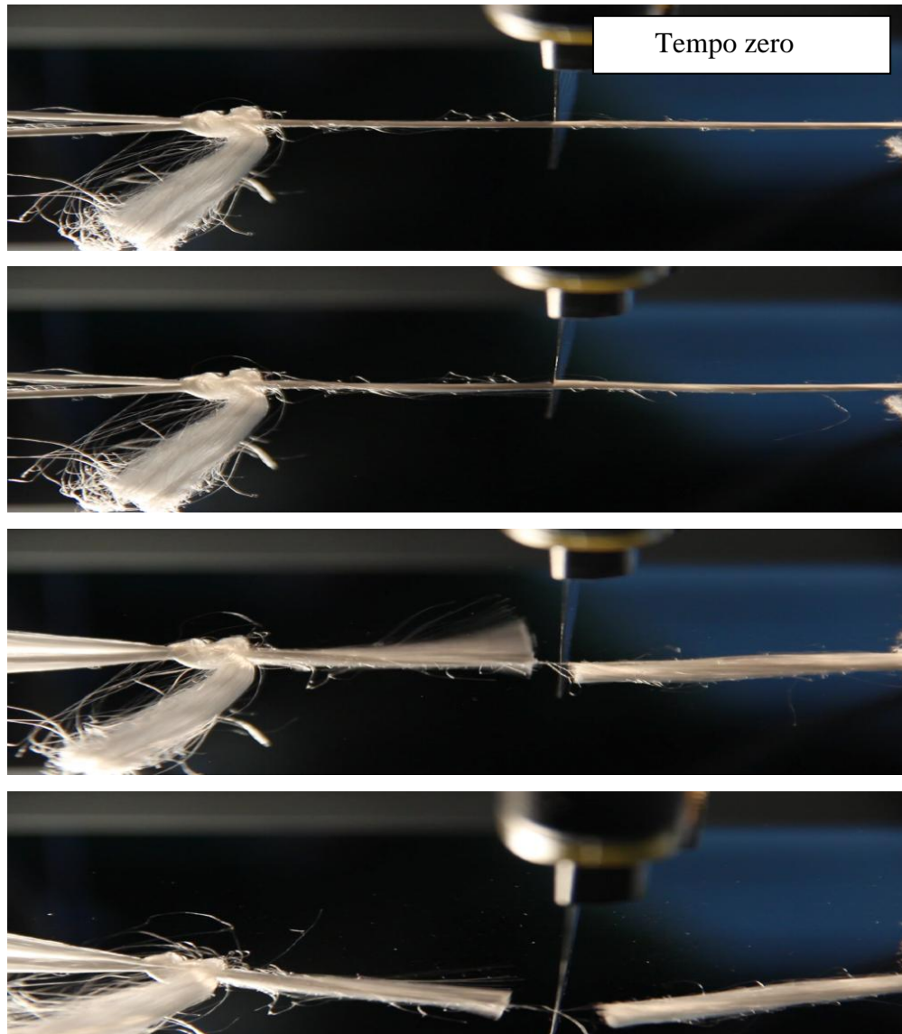
Figura 48: Alcune immagini relative alla recisione del campione L. 25 FPS
