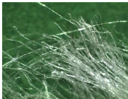
Figura 30: terminazioni parzialmente fuse del campione L.
