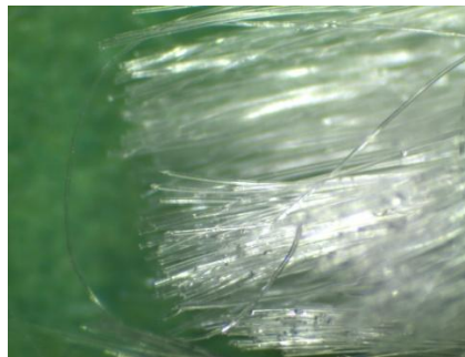
Figura 29: Terminazioni non fuse del campione I.
