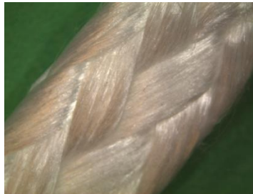
Figura 24: immagine registrata al microscopio ottico. Campione N: struttura compatta dopo trazione al dinamometro.
