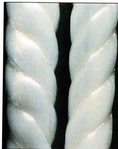
SOPRA: Particolare dell'intreccio di stoppini (in genere se ne impiegano 48) che formano la camicia della corda. Sono appena distinguibili i filamenti che li costituiscono.
