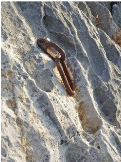
Placchetta e maillon di acciaio zincato di bassa qualità risalente a 20 anni fa Photo by M. Oviglia
