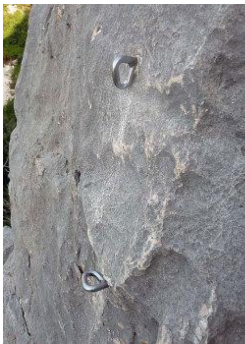
Fittoni inox di calata di una sosta alla francese, chiaramente consumato dalla corda Photo by M. Oviglia
