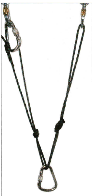
Fig. 2: Sosta fissa con unico nodo sui rami (sinistra) o nodi separati sui singoli rami (destra).
