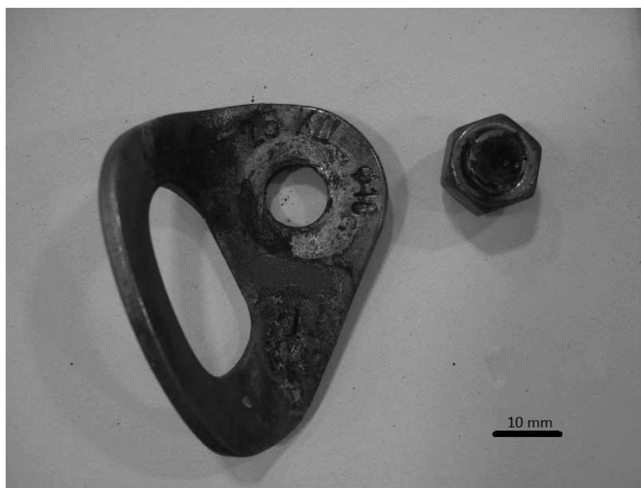
Figura 7.42: Campione #11. Per le analisi si è utilizzata la parte rotta in esercizio, costituita dalla coppia dado-tassello
