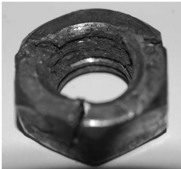
Figura 7.25: Campione #7. Si noti l'importante attacco corrosivo (distanza fra lati paralleli: 12 mm)
