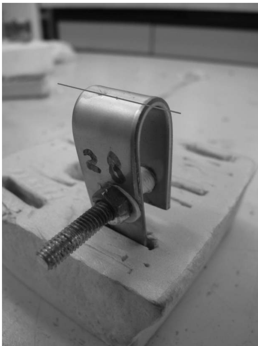
Figura 8.1: Campioni fase 2: la linea rossa indica la direzione di sezionamento
