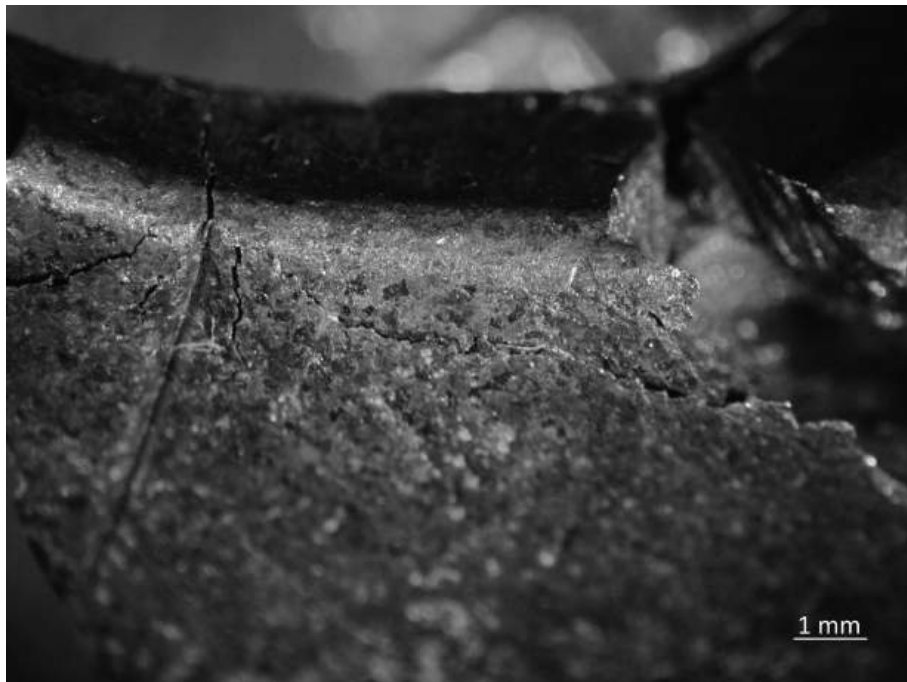
Figura 7.22: #6: Una delle parti ottenute dopo la rottura lungo la cricca mostrata in figura 7.21 nella pagina precedente. Si notino le cricche percorrenti il campione, con conseguente struttura altamente indebolita del pezzo
