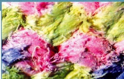
combinato dello sfregamento sulla roccia, delle sollecitazioni meccaniche (moschettoni e freni), della polvere e dei microcristalli che penetrano nella camicia è il principale fattore d'usura delle corde. Contano i metri di arrampicata, non il tempo d'impiego.
