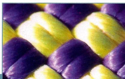
Fig. 6a e 6b - Dopo 49 calate col discensore Robot, la camicia della corda appare ancora perfettamente integra, come confermato anche dai risultati del test di Dodero
