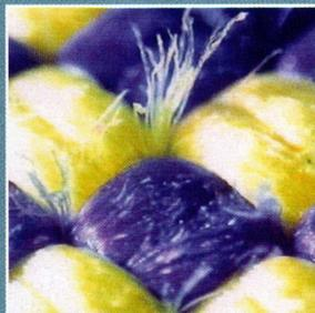
**Fig 5a, 5b, 5c, 5d** - Danni alla camicia di corda dopo una successione di 7 e 49 discese a corda doppia col discensore Otto. È ben visibile la caratteristica peluria superficiale -dopo 49 discese- che sta ad indicare la presenza di numerose bave rotte, come si nota nella foto del particolare
