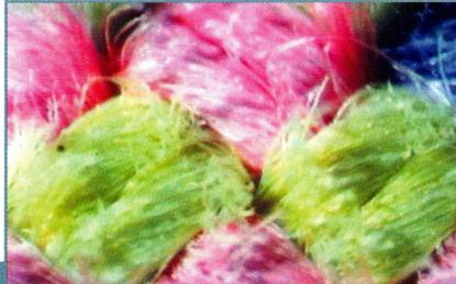
**Fig. 4a e 4b** - Danni alla camicia per sfregamento della corda sulla roccia. È evidente come le abrasioni superficiali della camicia, facilmente rilevabili anche ad occhio nudo, non siano altro che rotture di parte di filamenti come appare chiaramente nella foto del particolare
