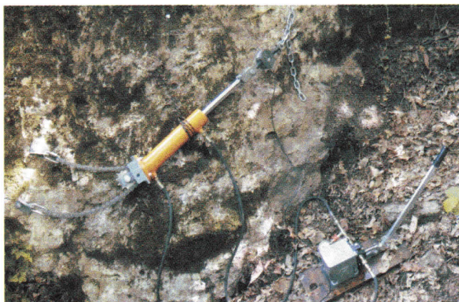
Figura 6: Il sistema di estrazione lenta durante una prova con cella di carico
