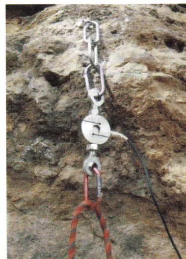
Figura 1: Le celle di carico sul rinvio ed in sosta. Si noti la protezione intorno alla cella di carico in sosta
