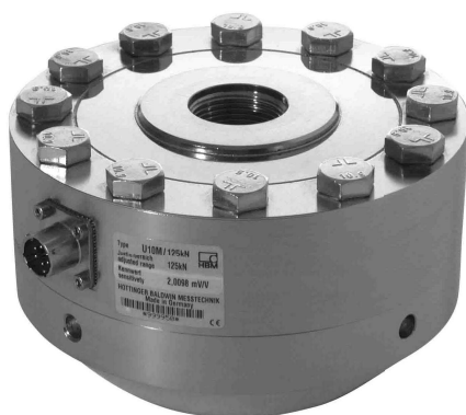
Fig. 15: Cella di carico HBM del CSMT del CAI
