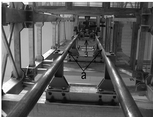
Fig. 23: Guide (a) e massa in caduta (parte 3)
