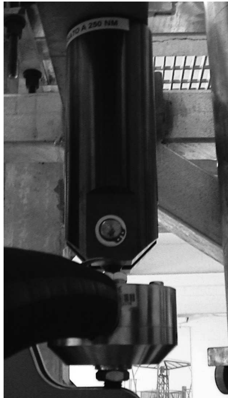
Fig. 27: Cella di carico (parte 4) con sopra il fissaggio sulla struttura portante e sotto il fissaggio al telaio dove sono posti anche lo "strizza-corda" e lo Sharp Edge
