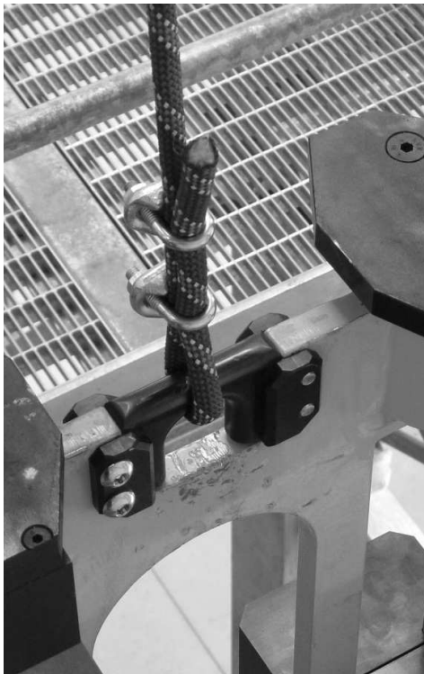
Fig. 21: Collegamento corda-massa tramite morsetti nella prova VSD.
