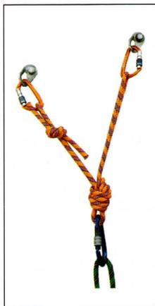
Fig. 6 - Sosta fissa classica a nodo singolo
